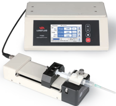
TFD02-01分体注射泵执行单元 适用一支10 \mu L-60 \mu L的注射器 线速度1 \mu m/min -150mm/min
